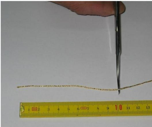
4) Schneiden Sie von der Kordel mit Hilfe einer Scherer und einem Lineal ca. 10 cm ab.
