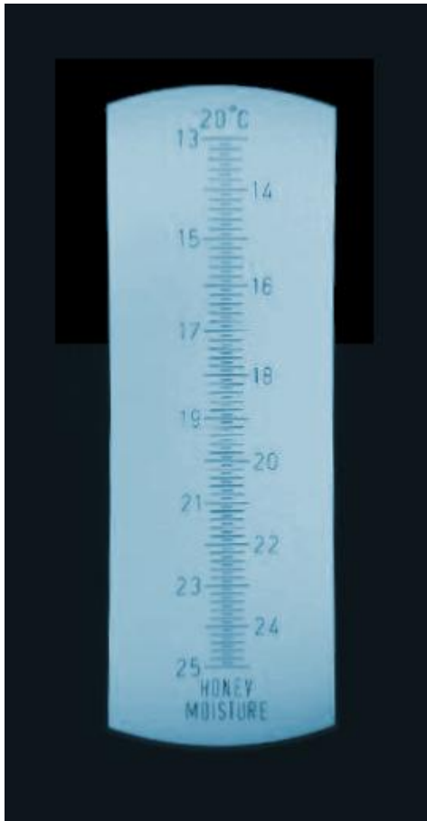
Abb. 2: Skala 13-25 % Wassergehalt im Honig
